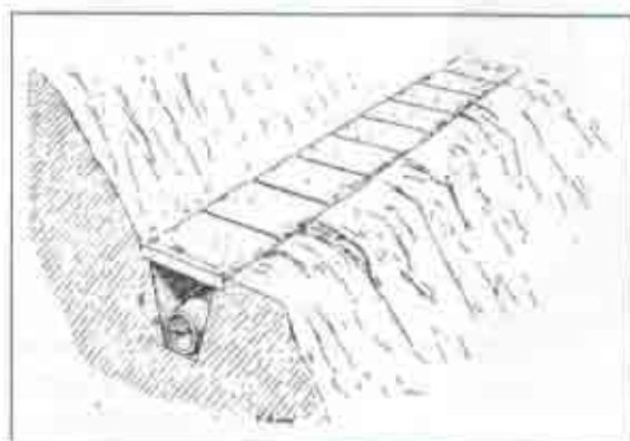
Abb. 8: Rekonstruktion der Wasserzuleitung Prienes nach Wiegand – Schrader, Abb. 37, S. 69.
